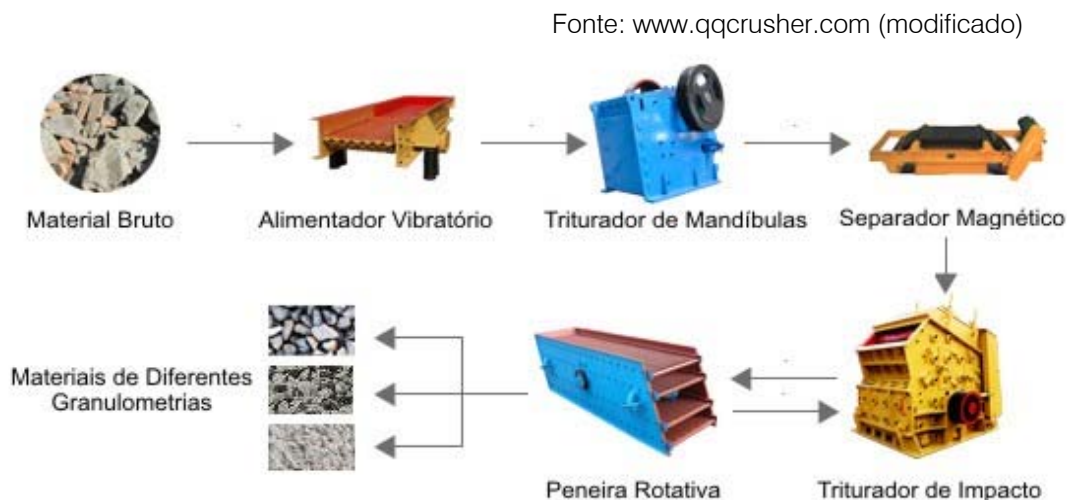
Figura 11 - Esquema de uma usina de reciclagem de RCC's.
